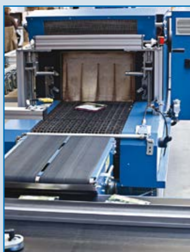
Bezúdržbový tunelový dopravník s akumulčním koncovým dopravníkem s počítačící funkcí
