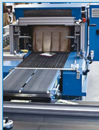
Bezúdržbový tunelový dopravník s akumulárnym koncovým dopravníkom s počítacou funkciou
