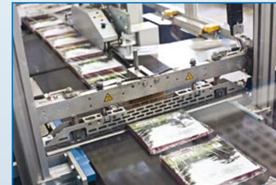
Pohyblivá („plávajúca“) priečna zväracia lišta je schopná uzavrieť do fólie až 150 výrobkov za minútu
